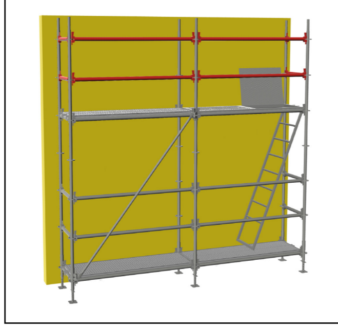
İkinci sıranın yatay elemanları yerleştirilir. Horizontal ledgers of the second level are placed.
