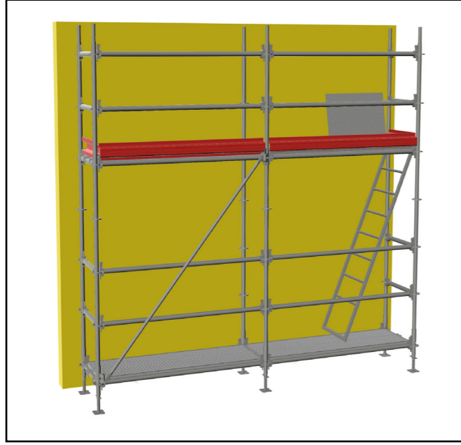
İkinci sıra kurulumu tamamlandıncı topukluklar yerleştirilir. Toe boards are mounted. The assembly of the second level is completed.
