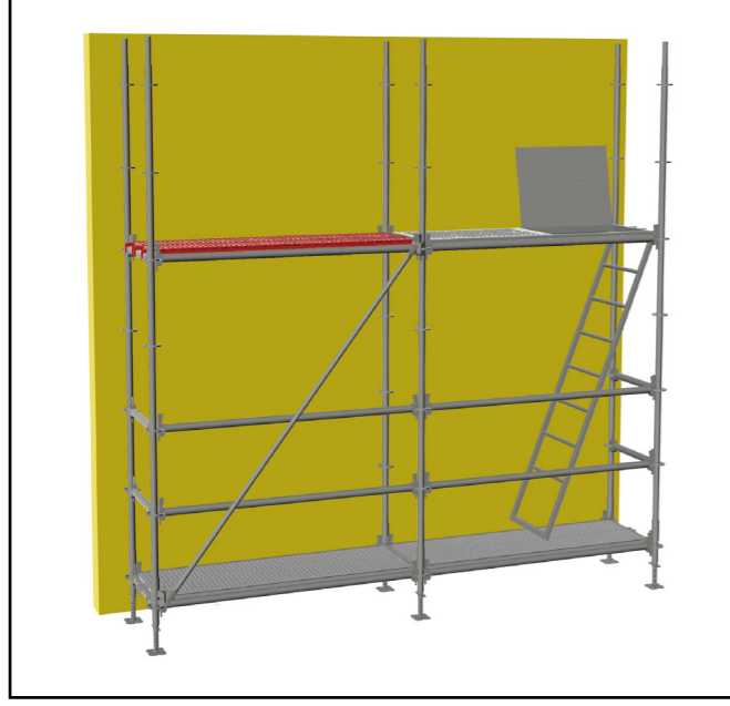
Metal platformlar , merdivenli platform hizasında yerleştirilir. Metal planks placed on the level of the ladder platform.
