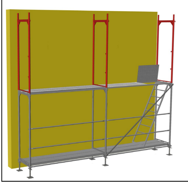
İkinci sıranın çerçeveleri yerleştirilir. yerleştirilir. H frames of the second level are placed.
